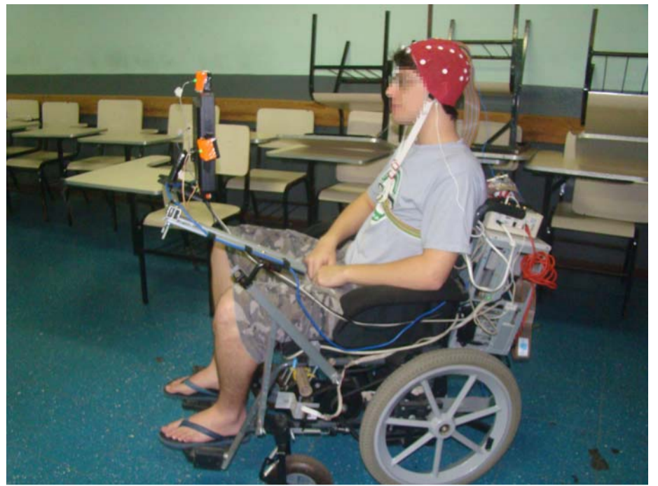
En la imagen, puede verse la silla durante su desarrollo experimental, en momentos de ser comandada por un usuario mediante el censado de sus señales cerebrales.
