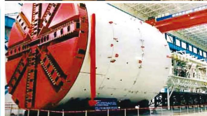
● Tuneledora Tunnel Boring Machine (TBM) que es una especie de tren de entre **70 y 100 metros** de largo con una cabeza provista de poderosos dientes de corte que al girar rompen la roca. La tuneledora excavará unos **10 kilómetros** y el resto se completará con voladuras.
